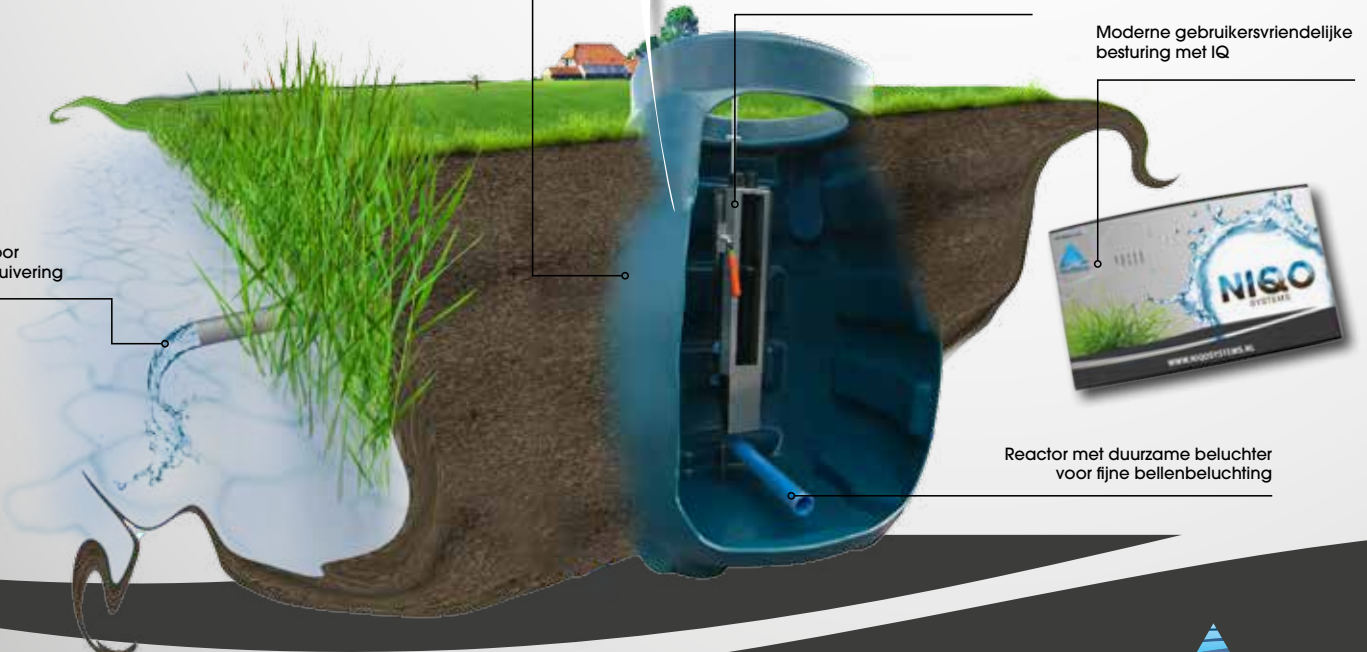
Nieuwe NIQO retrofit airliftmodule, gemakkelijk uitneembaar
